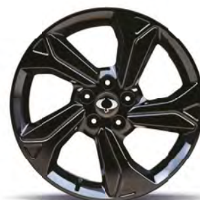
18" ALU disky Diamond Cutting - čierna, pneumatiky 215/50 R18
